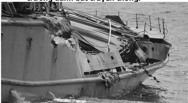
Toàn bộ phần lan can mạn trái sau lái, lan can tầng 1 sau lái tàu kiểm ngư bị biến dạng hoàn toàn. Xưởng chèo tải bên mạn trái cũng bị đâm thủng - Ảnh: My Lăng
